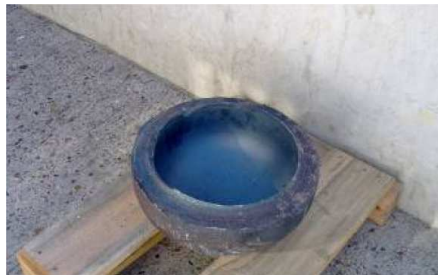
Figure 5 : Photographie du fond bombé projeté le jour de l'accident (source : GPN)
