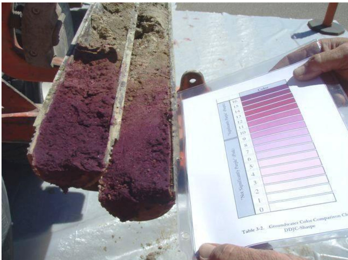
Figura 2.8- Ejemplo de perfil de difusión de oxidantes en núcleos de suelo de limo 90 días después de la introducción de una lechada oxidante de permanganato de potasio (foto cortesía de URS, archivo Bures)
