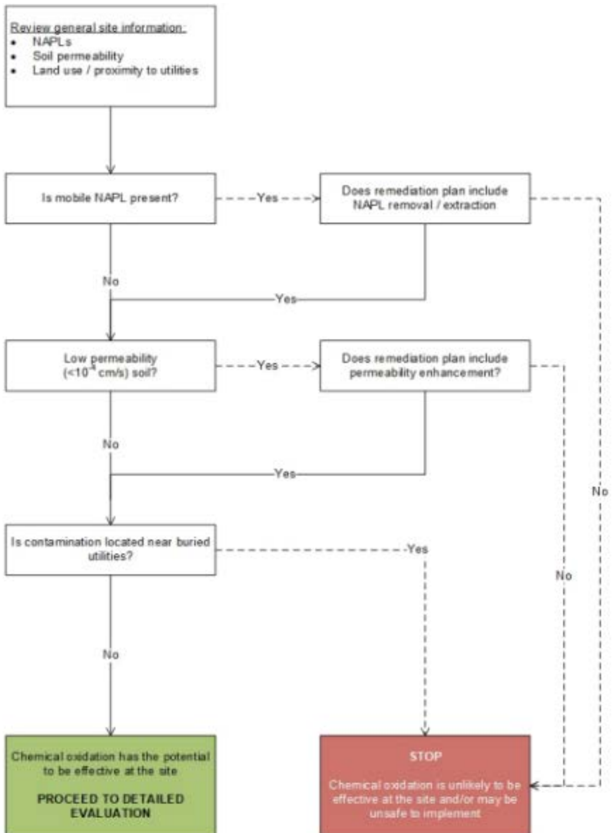
Εικόνα 3.1- Αρχικός έλεγχος για την πιθανή αποτελεσματικότητα ΕΤΧΟ, από την ΕΡΑ των ΗΠΑ (2004)
