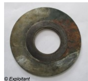
© Exploitant Joint de la bride en amont du débitmètre
