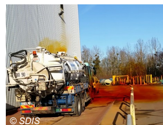
© SDIS Dégagement de vapeurs nitreuses suite à une opération de dépotage réalisée sans supervision (ARIA 49018)
